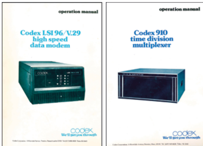
Beispielgeräte: Splitmodem, FDM (li.) und Multiplexer, TDM (re.)
